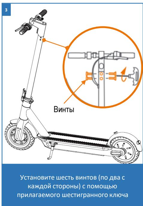
Установите шесть винтов (по два с каждой стороны) с помощью прилагаемого шестигранного ключа
