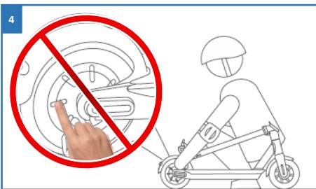
Під час їзди електромотор нагрівається, не торкайтесь до нього після їзди, оскільки можна отримати опік.
